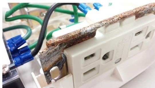
図 1. 電源タップ内部に輸液が浸透
