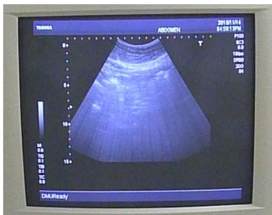
図 8 超音波診断装置への雑音の混入
