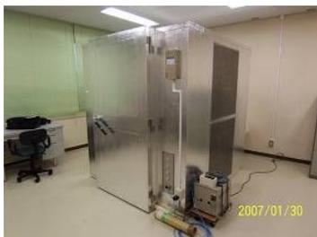
図 4 ユニット式電磁波遮蔽室
